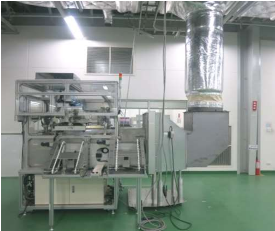
Hình 4.2. Hệ thống xử lý bụi sơn, hơi dung môi – dây chuyền sản xuất trực máy in
